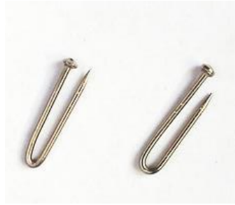
شکل ۴۴-۲: سوزن ته گرد خم شده به عنوان پایه موتور
