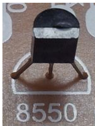
شکل ۱۹-۲: محل قرار گرفتن ترانزیستورها بر روی بُرد. کنار هر کدام از ترانزیستورها شماره ترانزیستوری که باید در آن محل قرار بگیرد نوشته شده است.
