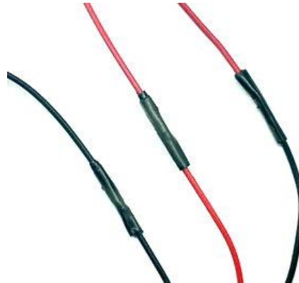
شکل ۵۰-۲: محل اتصال دو سیم را با چسب برق (لنت) بپوشانید تا به یکدیگر اتصالی نکنند.
