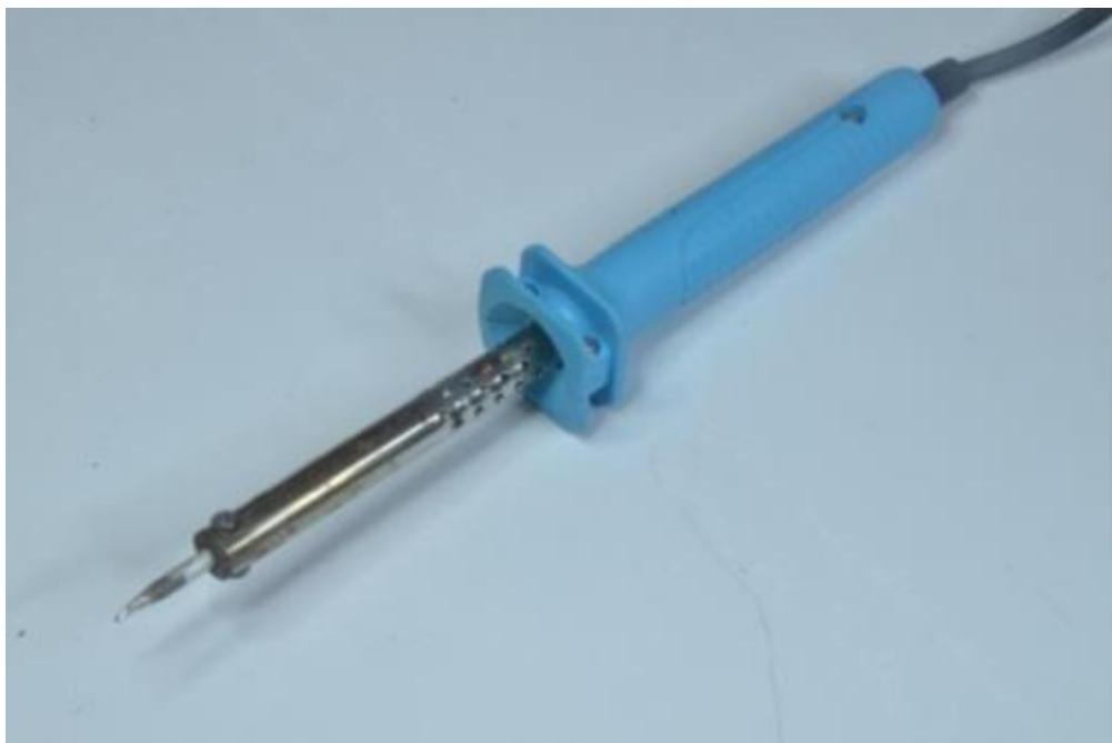
شکل ۱-۲: شکل ظاهری هویه
