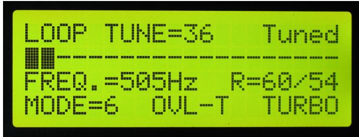
ارقامی که روی نمایشگر LCD نشان داده می‌شوند عبارتند از حالت تیون و مدار و مقدار فرکانس کار مدار و نیز مقدار خروجی انتگرатор ALL METAL سمت چپ و انتگرator DISC سمت راست، وضعیت تون اورلود و توربو و نیز بارگراف که میزان دامنه خروجی را نشان میدهد.
